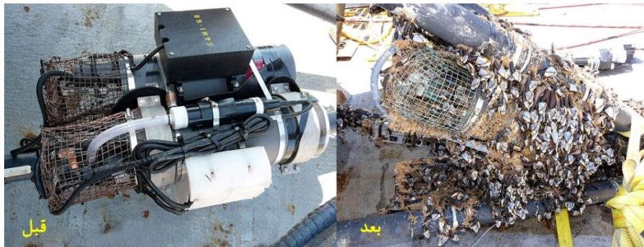
شکل ۳-۲۲ فولینگ‌زیستی ناشی از کشتی‌چسب‌ها و جلبک‌ها (عکس از: Jeff Schilling).
