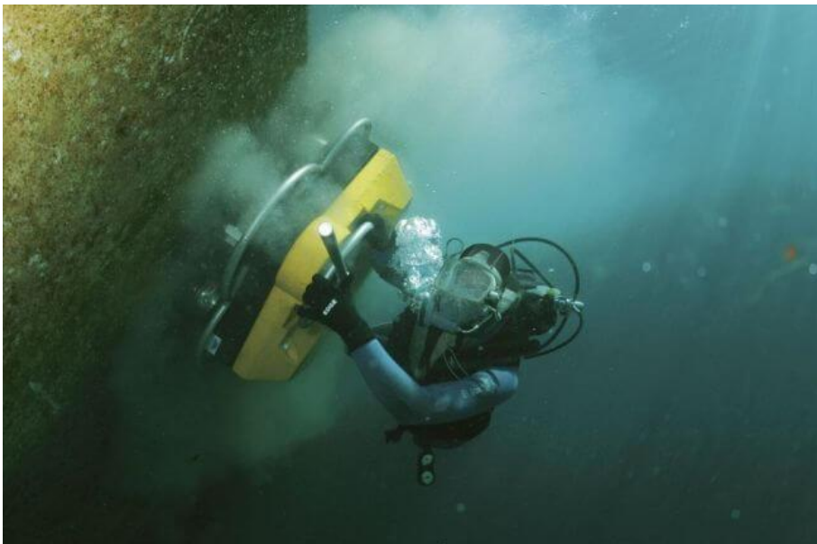
شکل ۳-۲۳ پاک‌تراشی سطوح فولینگ زیستی با برس مکانیکی (عکس از: us.v-cdn.net).
