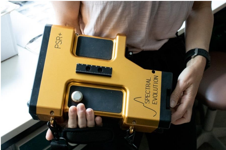
شکل ۳-۱۹ دستگاه طیف‌سنج نوری که بر پهپاد سوار می‌شود و با سنجش از دور به شناسایی درختان آلوده به قارچ می‌پردازد (عکس از Caro Silova، دانشگاه مینه‌سوتا).
