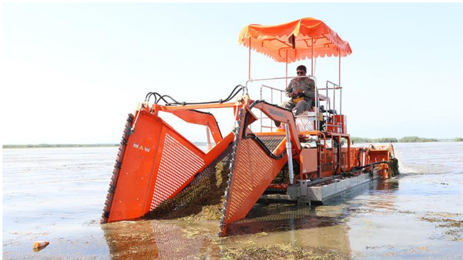
شکل ۵-۱۲ شناور برداشت‌کننده گیاهان غوطه‌ور (آزولا، سنبل آبی و سایر گیاهان مزاحم) در تالاب انزلی خریداری شده از کانادا (عکس: خبرگزاری ایرنا).
